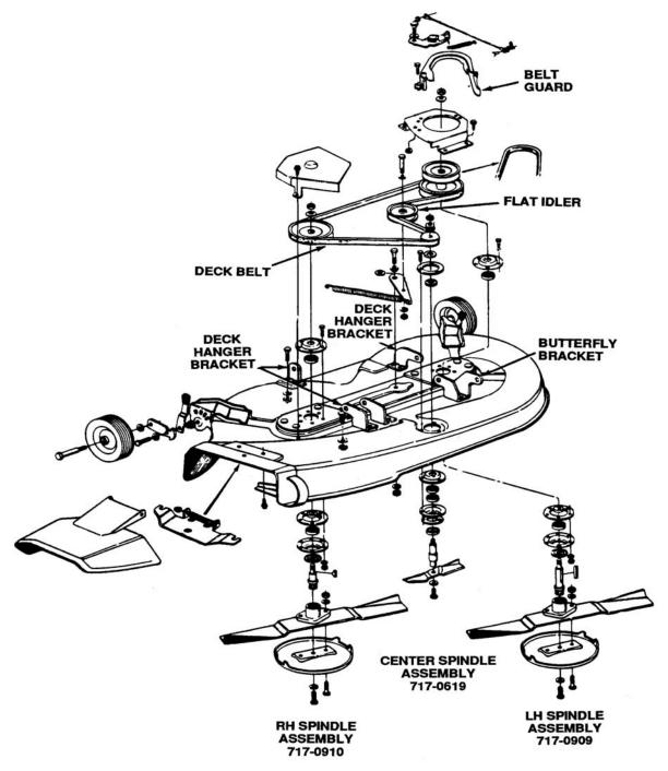
Figure 8-1. Model 803 44-Inch Side Discharge Deck
