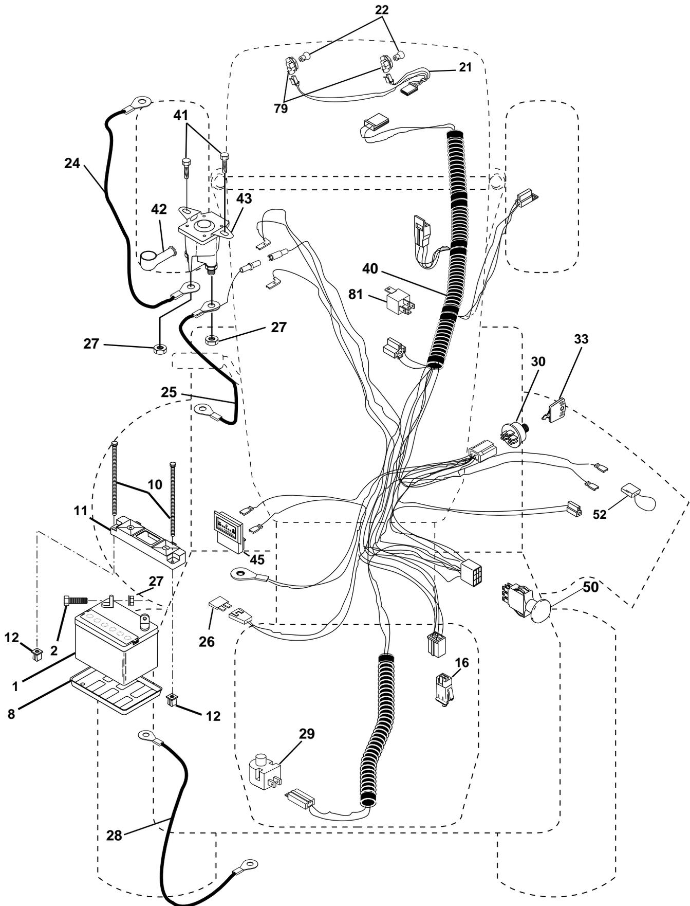
**PIÈCES DE RECHANGE****TRACTEUR - NUMÉRO DE MODÈLE PRGT2046B****ÉLECTRIQUE**
