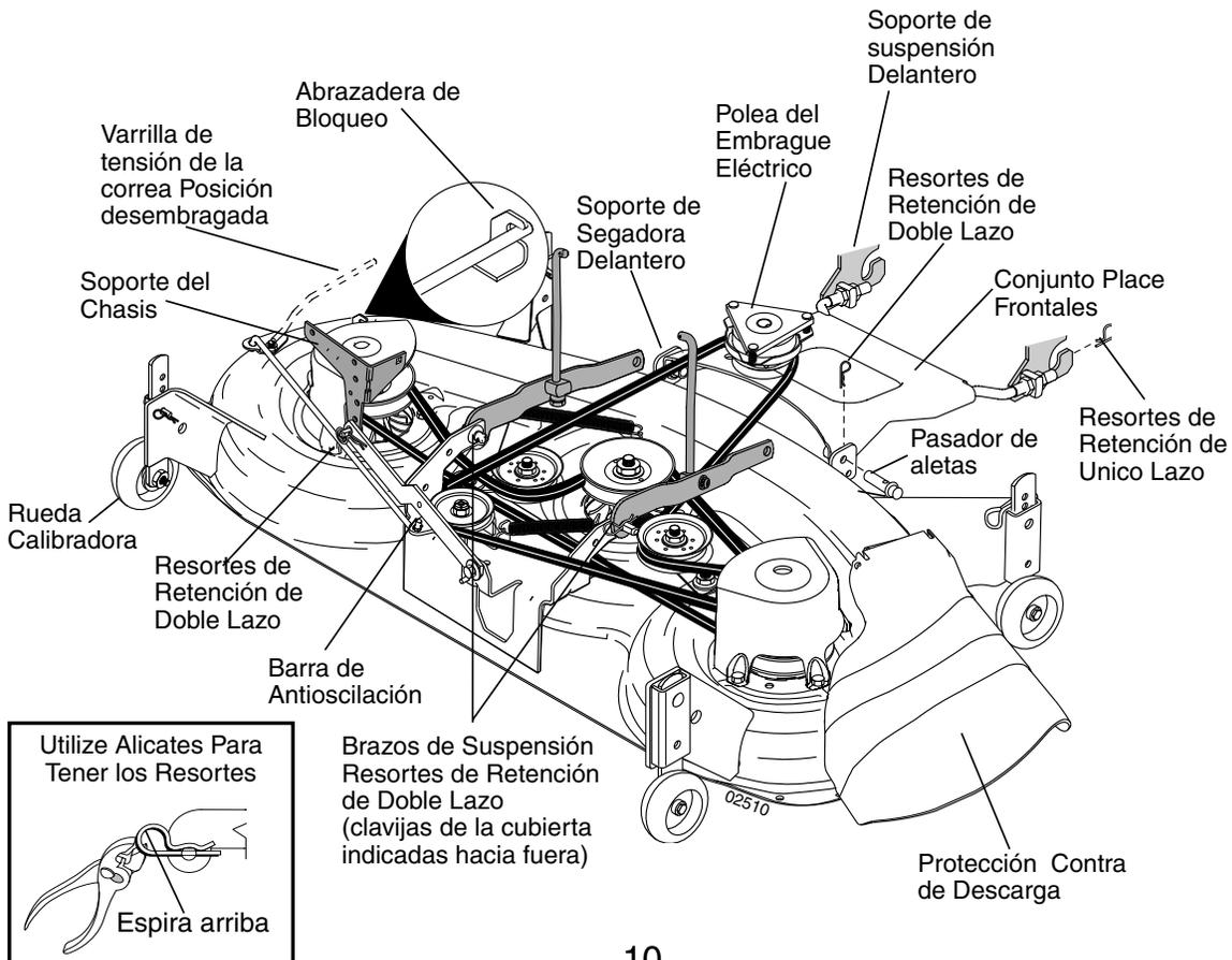
**⚠ PRECAUCIÓN:** La barra de la tensión de la correa esta cargada por resorte. Agarre tensamente la barra y enganchela lentamente.
