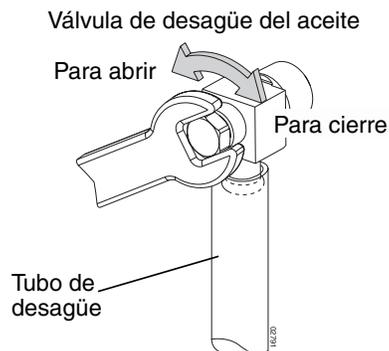
4. Después de drenar completamente el aceite, cerrar la válvula de drenaje girando en el sentido de las agujas del reloj. Usar la llave inglesa de 7/16" (11mm) para aplicar una pequeña torsión para mantenerla cerrada. No apretar más de lo necesario.
