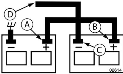
Batería Débil o Descargada      Batería Completamente Cargada
