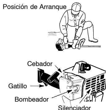
**ADVERTENCIA:** El cabezal de corte girará mientras se esté intentando poner en marcha el motor. Evite el hacer ningún tipo contacto con el silenciador. Un silenciador caliente podría provocar quemaduras de gravedad si se toca.
