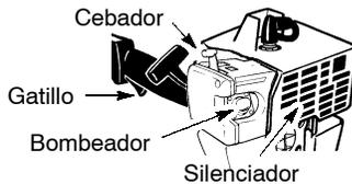
**ADVERTENCIA:** El cabezal de corte girará mientras se esté intentando poner en marcha el motor. Evite el hacer ningún tipo de contacto con el silenciador. Un silenciador caliente podría provocar quemaduras de gravedad si se toca.
