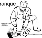
**ADVERTENCIA:** El cabezal de corte girará mientras se esté intentando poner en marcha el motor. Evite el hacer ningún tipo de contacto con el silenciador. Un silenciador caliente podría provocar quemaduras de gravedad si se toca.
