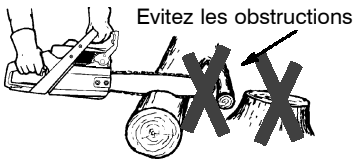
Dégager l'endroit du travail
