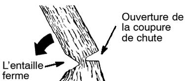
**REMARQUE:** Avant d'achever la coupe de chute, employez des cales pour ouvrir la coupe si nécessaire afin de contrôler la direction de chute. Employez des cales en plastique ou en bois, mais jamais en acier ou en fer, afin d'éviter de recul et des dégâts à la chaîne.
