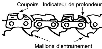
6. Passez la chaîne par dessus l'embrayage et derrière lui, adaptant les maillons d'entraînement dans le pignon de tambour de l'embrayage.
