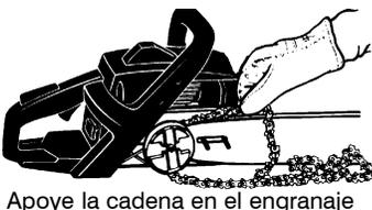
**TENSION DE LA CADENA** (inclusive los aparatos con la cadena ya instalada)
