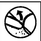
**ADVERTENCIA:** Debe evitarse cualquier contacto de la punta de la barra guía con cualquier objeto, ya que puede causar que la barra guía se desplace repentinamente hacia arriba y hacia atrás, con posibles graves heridas.
