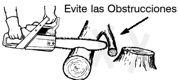
Despeje el Area de Trabajo
