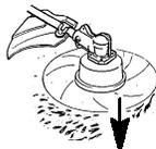
Frappez toujours la tête de coupe sur un endroit où pousse de l'herbe. Si on la frappe sur du ciment ou de l'asphalte, on peut causer une usure excessive de cette pièce.
