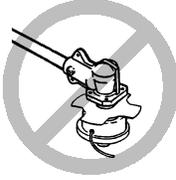
**⚠ AVERTISSEMENT:** N'utilisez pas la tête de coupe pour y attacher la lame. Arrêtez la lame qui fait roue libre en la mettant en contact avec du matériau coupé.
