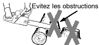
Dégager l'endroit du travail
