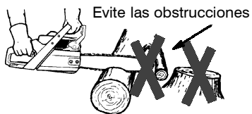
Despeje el Area de Trabajo
