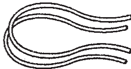
Parties en rotative de la Tondeuse (2) Sets (0.130 diamètre x 16.75 pounces Longueur)
