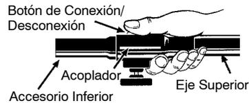
3. Mientras sostiene el eje superior con firmeza, retire el accesorio inferior del acoplador en forma recta.
