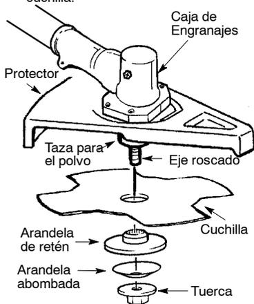
6. Coloque la arandela abombada en el eje. Asegúrese de que el lado más ancho de la arandela esté orientado hacia la cuchilla.
