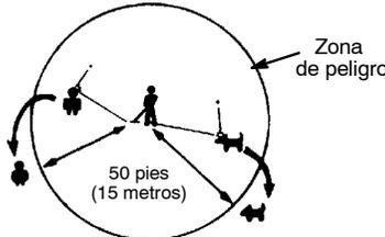
**⚠ ADVERTENCIA:** La cuchilla sigue girando incluso después de soltar el acelerador o de apagar el motor. Incluso cuando está girando libremente, la cuchilla puede despedir objetos o causar cortes profundos si se toca accidentalmente. Detenga la cuchilla poniendo en contacto el lado derecho de la misma con material ya cortado.
