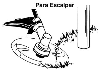
**PARA CORTAR CÉSPED** - Este aparato es ideal para cortar césped en lugares donde las cortadoras convencionales no llegan. En posición de cortar césped, mantenga la línea paralela al suelo. Evite presionar el cabezal contra el suelo, ya que de hacerlo podría escalpar la vegetación y dañar el aparato.
