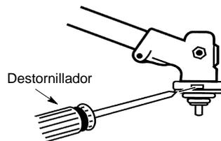
3. Sujete el destornillador en su posición y remueva el cabezal de corte dando vuelta a la derecha.
