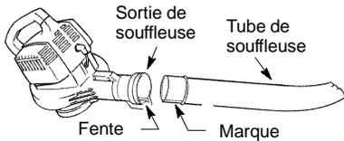
2. Fixez le tube en tournant le bouton dans le sens des aiguilles d'une montre.
