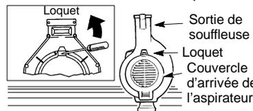
3. Soulevez doucement le bout du tournevis vers l'arrière de l'appareil à ouvrir la loquet en tirant sur le couvercle de l'arrivée de l'aspirateur avec l'autre main.
