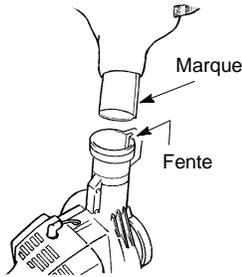
5. Introduisez le tube coudé dans la sortie de souffeuse. Assurez-vous que le marque du tube coudé est aligné avec la fente de la sortie de souffeuse.
