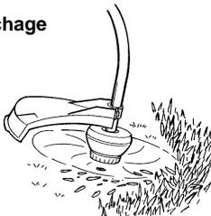
**BALAYAGE** - Vous pouvez utiliser l'action de balayage du fil de coupe pour nettoyer vite et facilement. Maintenez le fil parallèle aux surfaces balayées et au dessus d'elles et bougez l'appareil d'un côté à l'autre.
