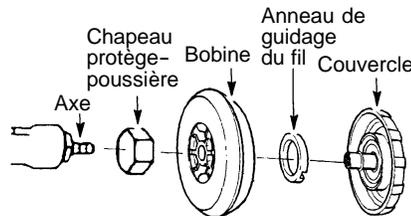
Utilisez une bobine pré-enroulée ou remettez du fil dans la bobine. Si vous utilisez une bobine pré-enroulée, enlevez la bande de ruban du fil et de la bobine.
