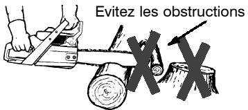
Dégager l'endroit du travail
