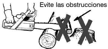
Despeje el Area de Trabajo
