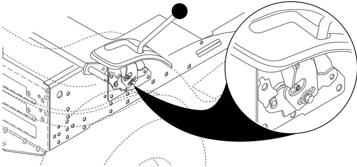
**NEUTRAL ADJUSTMENT FOR GEAR DRIVE SHIFT LEVER**
