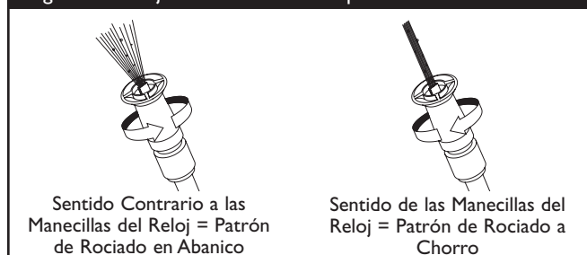
Figura 28 — Ajustar el Patrón de Aspersión
